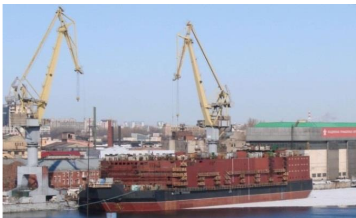
建造中の浮揚型原子力発電所(於バルチック造船所)
