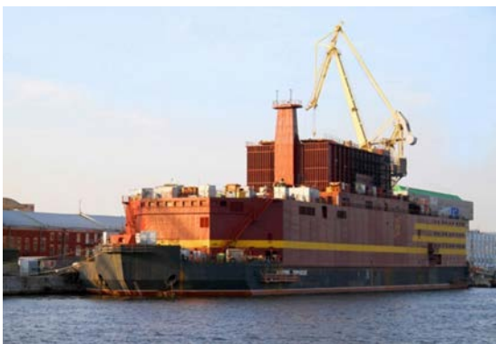
浮揚型原子力発電所“アカデミック・ロマノソフ” （サンクトペテルブルグのバルチック造船所にて係留試験中）
