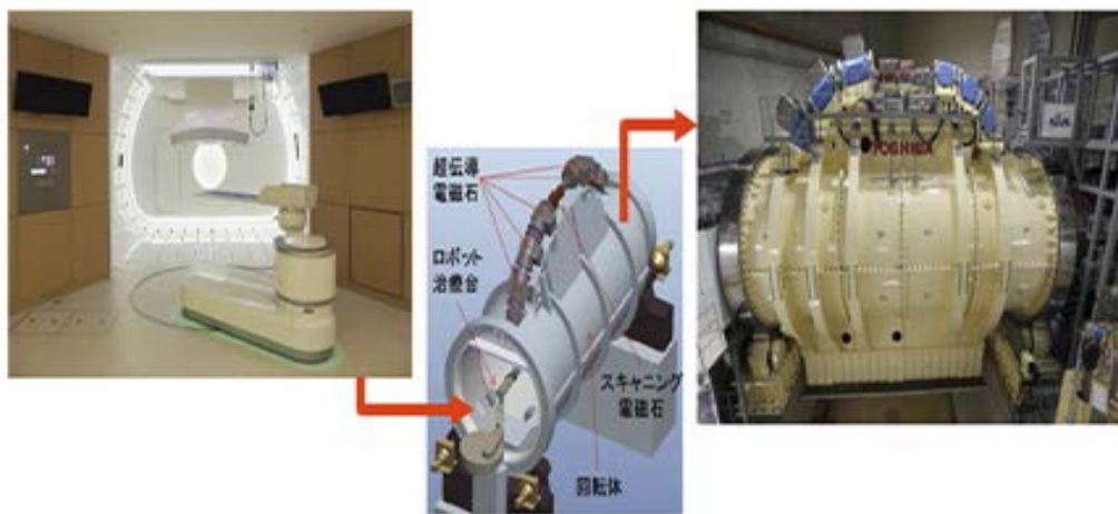
図1. 放医研に完成した重粒子線回転ガントリーと治療室 左: 治療室、中央: 模式図、右: ガントリー
