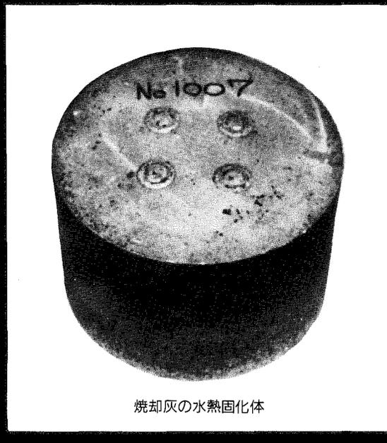
焼却灰の水熱固化体
