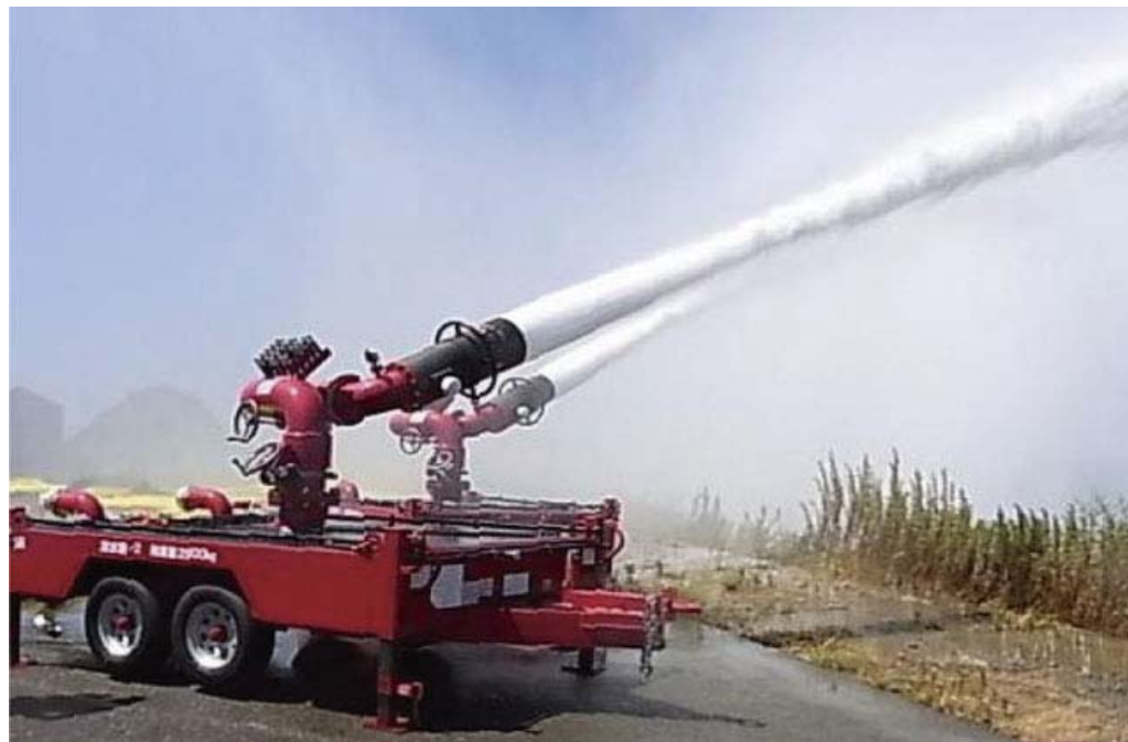
対策イメージ(大容量泡放水砲システムによる放水)
