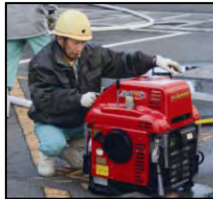
可搬型消防ポンプ(8台)
