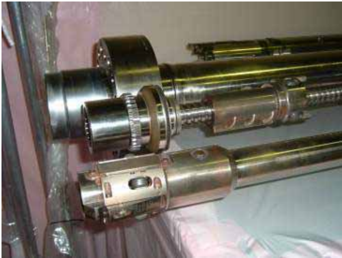
FMCRD 分解検査
