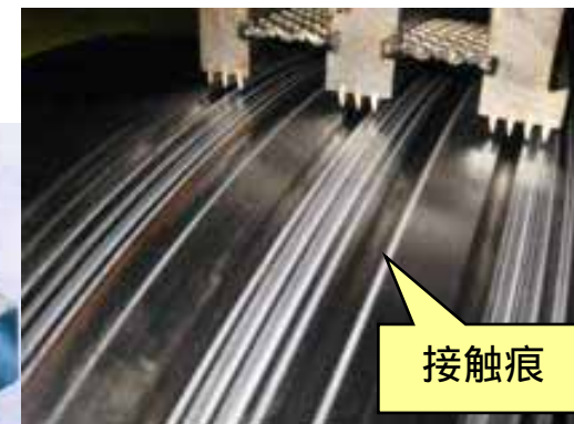
コレクタ側内側油切り接触痕
