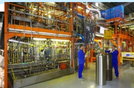
マルクールにおける原子力環境適合のコールドクルーシブル溶融装置を搭載した進化ガラス固化プロトタイプの大規模観
