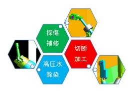
超高圧水を用いた原子力発電所の除染装置や保守装置の製作実績をもとに、自社開発した特殊環境向け多関節ロボットを展示します。水深30mでの作業や、人の立ち入ることが難しい高放射線環境下でも、7軸を同時制御して障害物を回避し、作業を安全・確実に行う遠隔多関節ロボットです。超高圧水切断ツール、超高圧水除染ツールなど様々な先端ツールを取り付けることができます。
