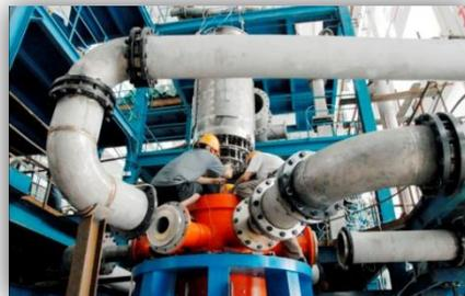
炉内構造物の流れ誘起振動模擬試験
