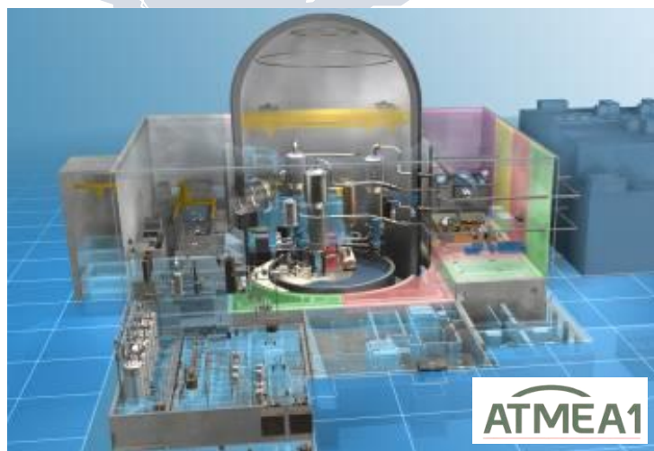
世界最高水準の安全性を誇る 日仏共同開発のGeneration III + 中型炉
