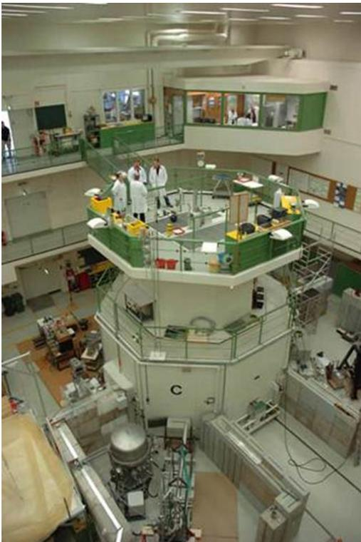
(図 1) ITU の TRIGA Mark II 研究・訓練炉
