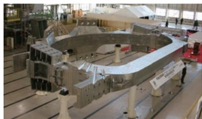
ITER「トロイダル磁場コイル」初号機 (1/30)
