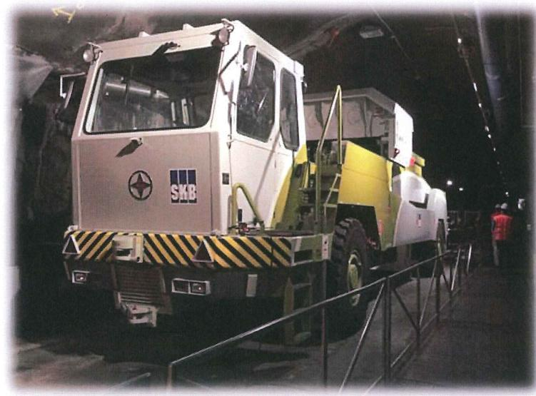
写真②キャニスタ輸送トラック (@エスボ岩盤研究所)
