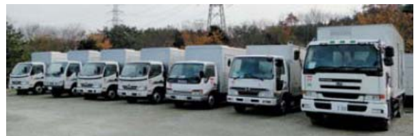
電源車(500~750kVA14台, このほかにガスタービン車 4500kVA2台)
