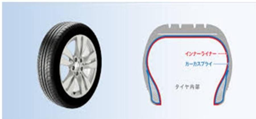
**\* タイヤのゴムの流動性を制御するため、タイヤの骨格の役割を持つ「カーカスプライ」や、タイヤの内部にはりつけて空気の透過を抑制する「インナーライナー」への放射線照射が行われている。**
