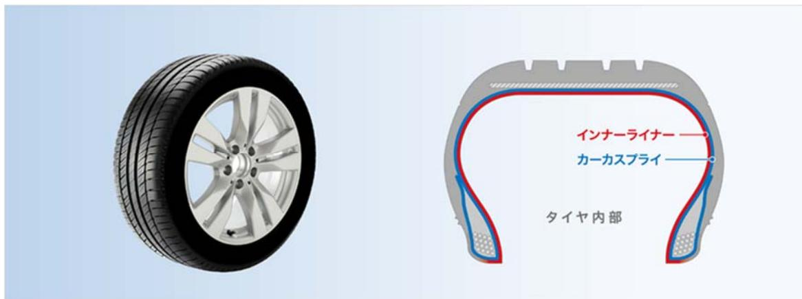
※タイヤのゴムの流動性を制御するため、タイヤの骨格の役割を持つ「カーカスプライ」や、タイヤの内部にはりつけて空気の透過を抑制する「インナーライナー」への放射線照射が行われている
