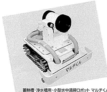
蓄熱槽・浄水槽用・小型水中清掃ロボット マルチくん
