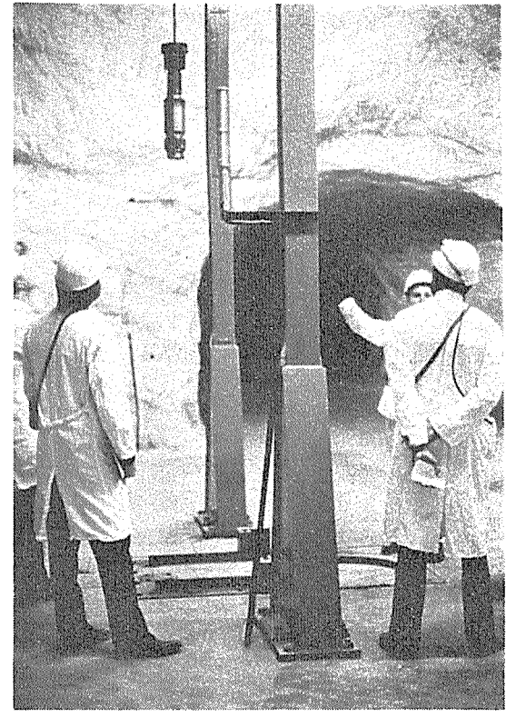
アッセ岩塩坑の中レベル放射性廃棄物投入装置。中央の円筒状のものが廃棄物の吊り具
