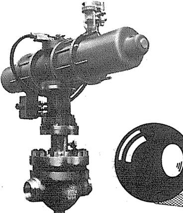
取り出して見れば、何の変哲もない孔の明いた金属のボールですが、このボールが実は、バルブの心臓なのです。これが、90度回転する度に、流体のON-OFF制御ができるのです。ボールバルブは構造が簡単で、操作し易く、理想的なバルブと言われていました。しかし、高圧流体には余り適さなかったのです。それを、61kg/cm<sup>2</sup>という高圧で、しかも、原子力用バルブに作り上げ、空気圧シリンダによる自動操作を完成しました。原子力発電所のバルブ耐圧部については、設計寿命30~40年とされ、垂直および水平両方向の、地震荷重等の検討も要求されます。これら、耐久性の考慮と同時に、原子力用バルブの大きな特色として、事故の皆無を追求し、高度な品質保証がなされております。
