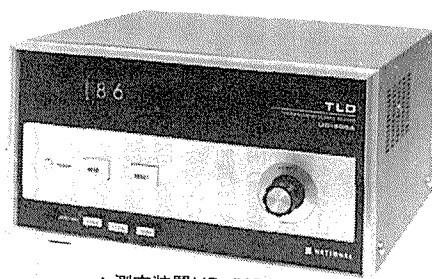
▲測定装置UD-505A (デジタル表示) 測定範囲:0.1mR~200,000R
