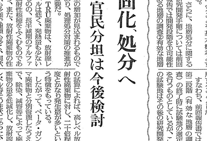
高レベル放射性廃棄物処分の調査・模範固化体現地試験の調査の五段階に区分して高レベル放射性廃棄物の処分については従来方針通り地層の調査を開始するにあたり、第一段階以降については、数百メートルの深地層中へ処分を行い、天然バリアと人工バリアを組み合わせた多重バリアによることを基本概念とする。
