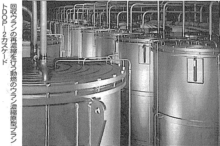
回収ウランの再濃縮を行う動燃のウラン濃縮原型プラントDOP-2カスケード
