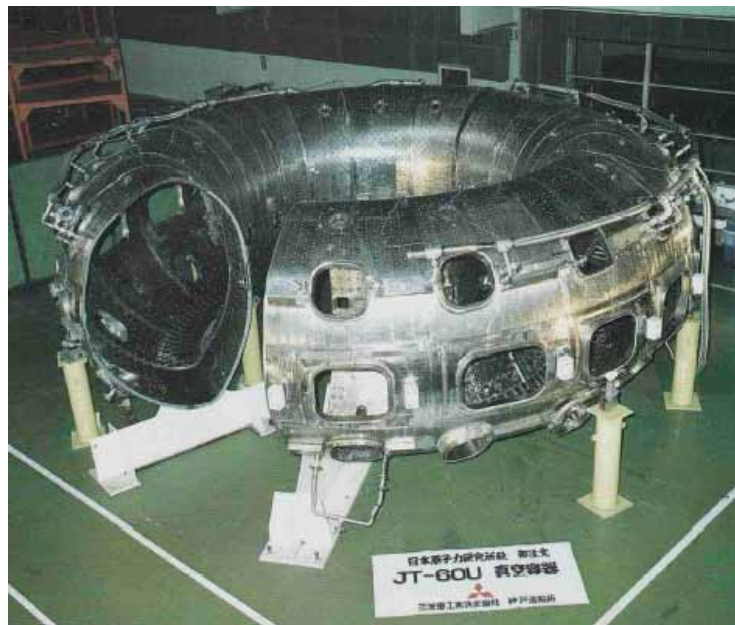
図 4.1.2-4 JT-60U 真空容器工場出荷前
