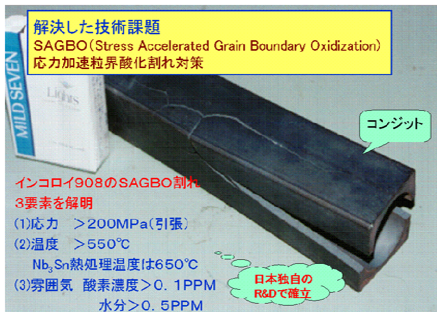
図 4.1.4-3 CS モデルコイル導体の SAGBO 割れ対策
