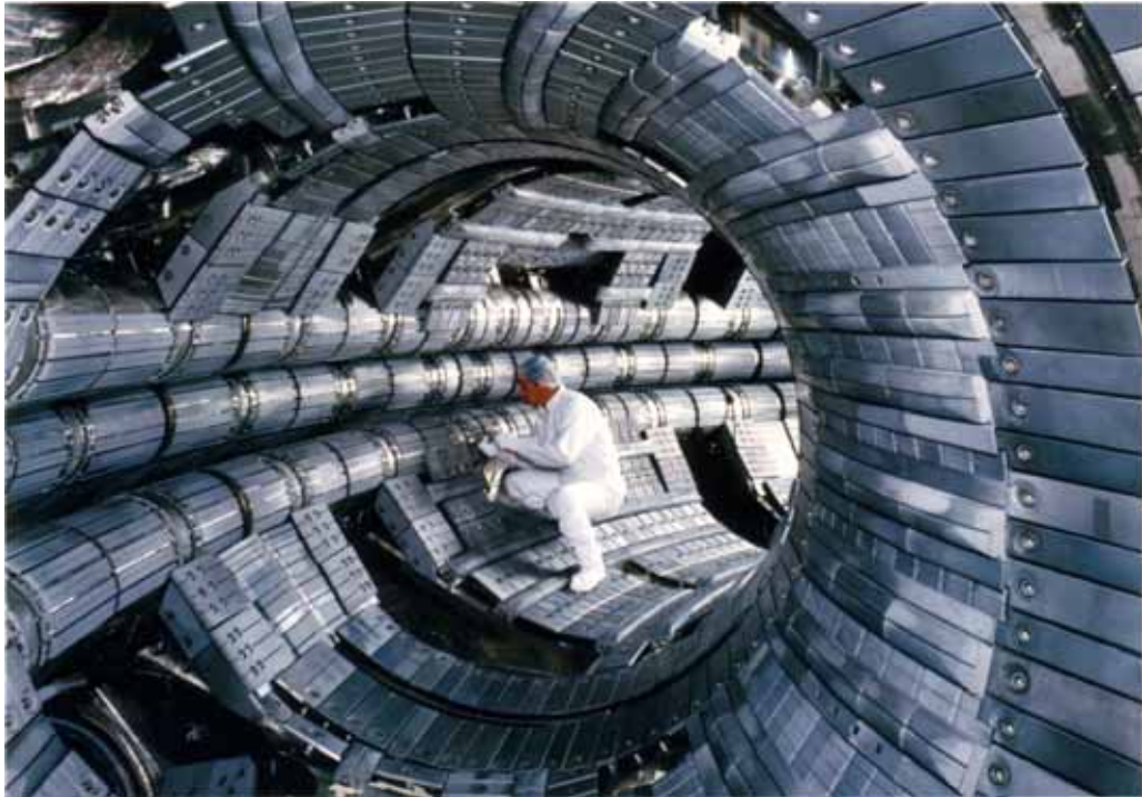
図 4.1.1-1(a) JT-60 の真空容器内部
