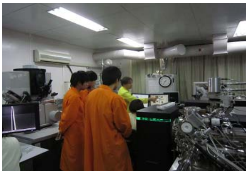
写真3 3Dアトムプローブ実習(東北大学) 材料中の原子の3次元的な分布を調べる最新の装置の操作を体験した。
