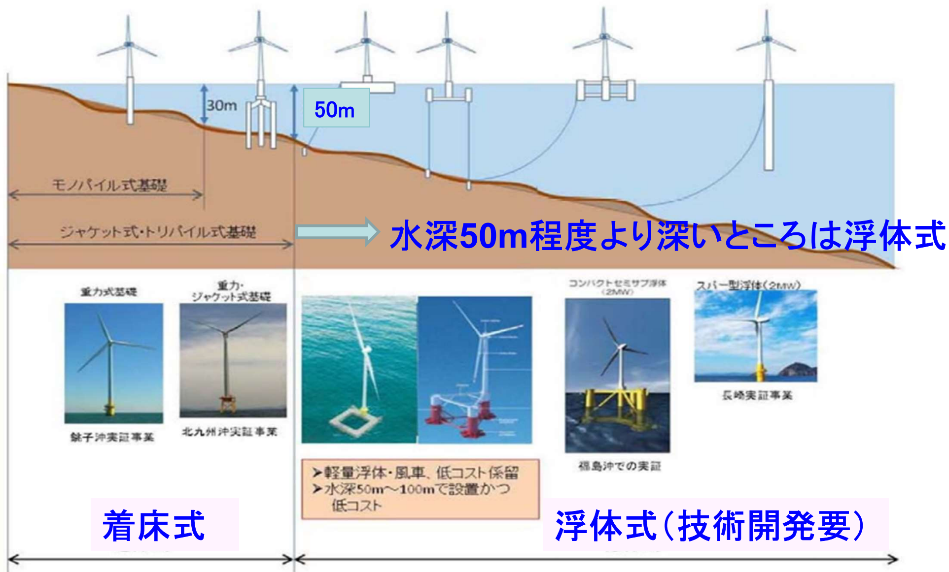
図 3.2-10 洋上風力発電施設の適用水深
